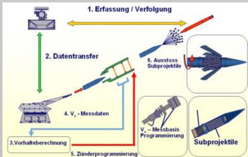
Abbildung 6: Funktionsprinzip AHEAD-Munition
